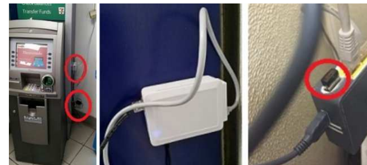
ネットワークケーブルに取り付けられたスキミング装置
