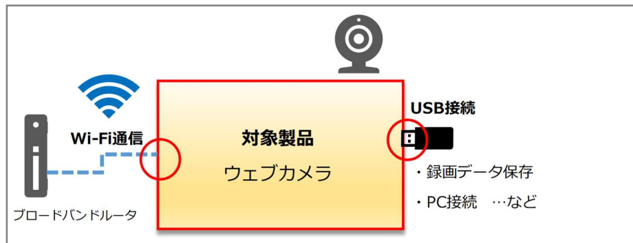
図3 対象インタフェースを実装したマーク対象製品の例3：ウェブカメラ
